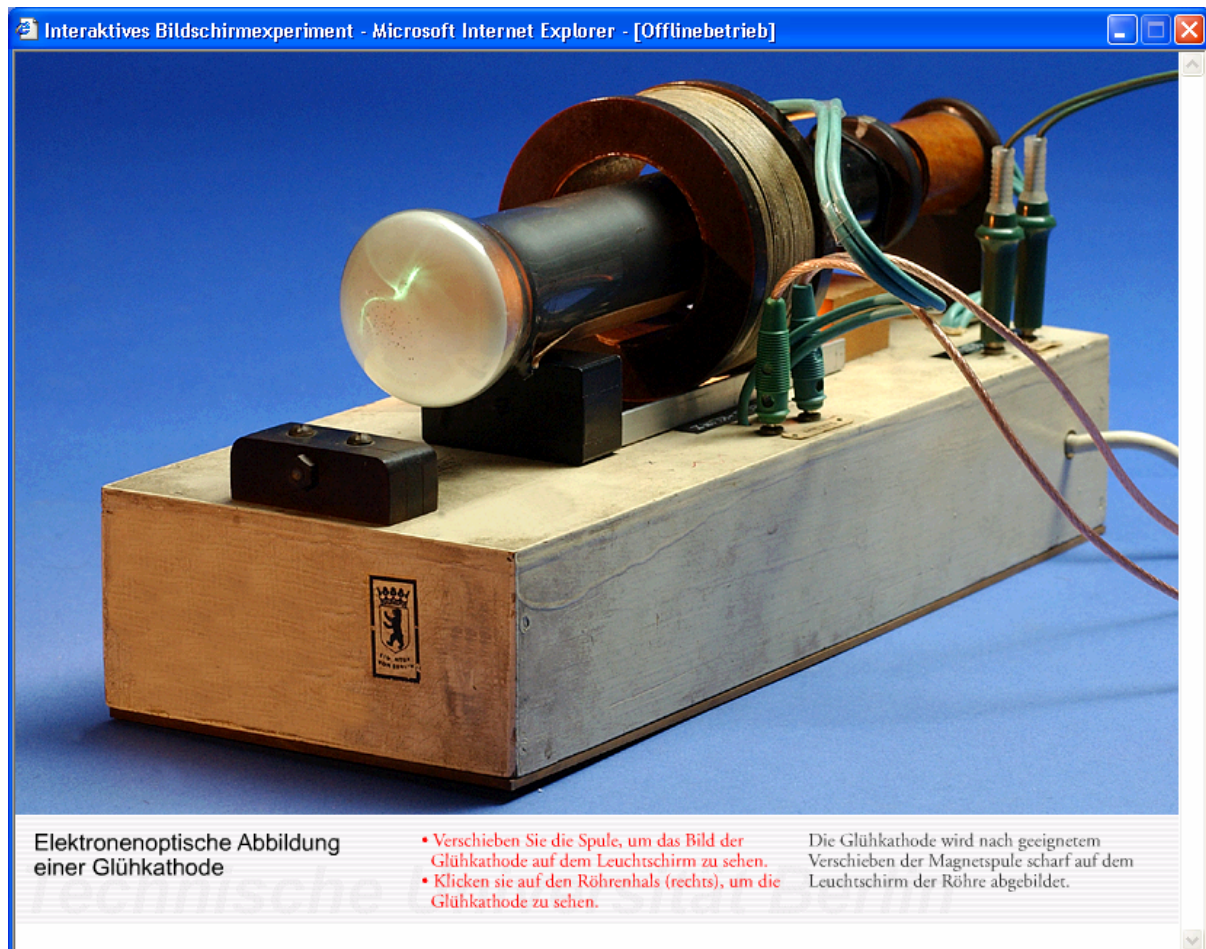
Abb. 1: Fokussierung des Bilds einer Glühkathode durch Verschieben der Magnetspule
